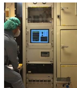
1996 installerades en syntesapparat för ^{11}\text{C} CH 3 I-baserade inmärkningsar i dedicerade hot-celler
