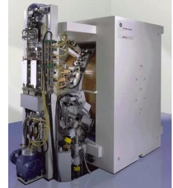
Karolinskas nya negativjon-cyklotron, PET-trace Foto: GE
