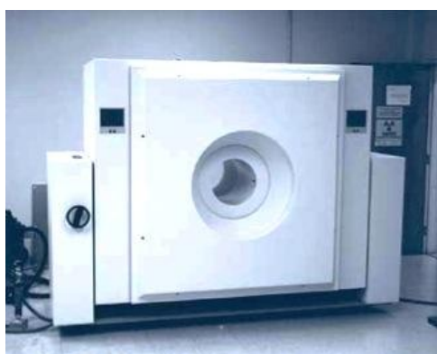
2007 installerades psykiatriktionens nya PET-kamera, Siemens ECAT High Resolution Research Tomograph, HRRT, som nog har den högsta upplösningen av humana PET-kameror.
